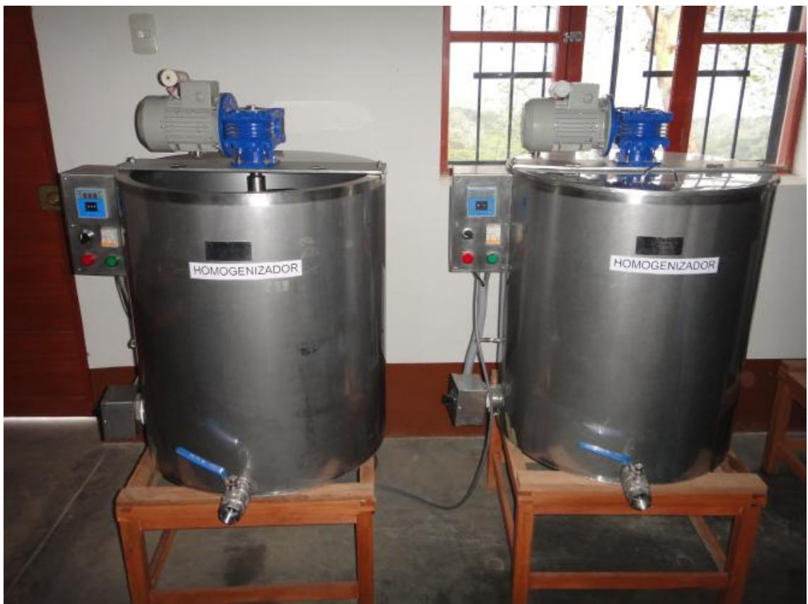
Foto 4. Homogenizadores de miel en planta procesadora
